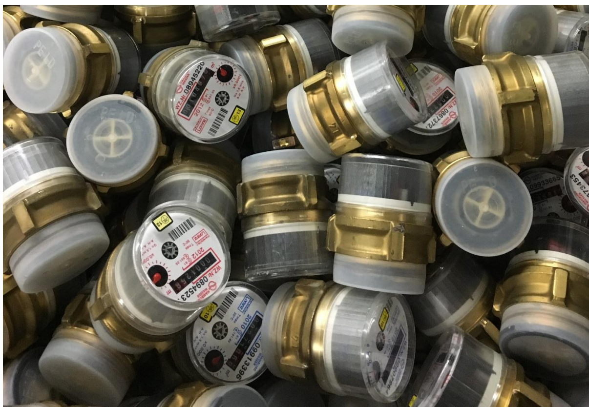
Abbildung 2: Ausgebaute Wohnungswasserzähler nach dem Ende der Nutzungsdauer (© Hamburg Wasser).
